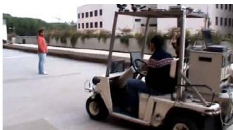
**Figura 1.10: Robot móvil Romeo-4R. Experimento de evitación de obstáculo.**
