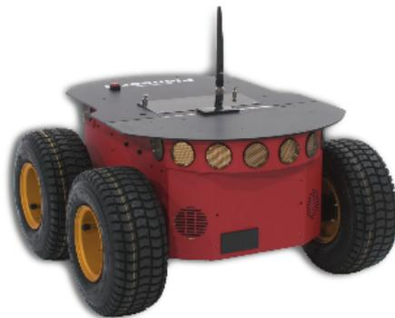
**Figura 1.4: Robot móvil Pioneer 3-AT.**
