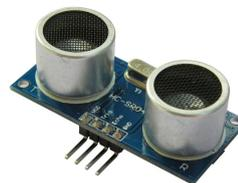
**Figura 2.5: Sensor de ultrasonido HC-SR04.**
