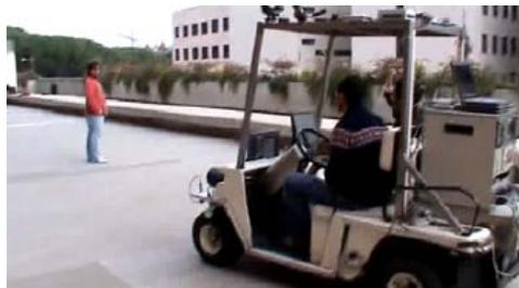
**Figura 1.5: Robot móvil Romeo-4R. Experimento de evitación de obstáculo.**
